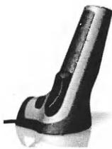
Помимо обычного пишущего стержня (гелиевого, к примеру) ручка оснащена миниатюрной камерой с микролинзовым объективом для фиксации изображения в прямоугольной координатной сетке и точного определения позиции пишущего узла, а также формы и толщины линии на поверхности бумаги.
