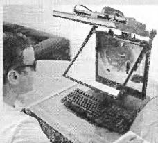
Изображение формируется на полупрозрачном зеркале, расположенном на биссектрисе угла между мониторами. Для получения стереоизображения необходимо использовать специальные поляризованные очки. Уникальность решения состоит в отображении высококачественной картинки, «наследующей» характеристики мониторов, — разрешение 1280x1024 точек, время отклика 12 мс.
